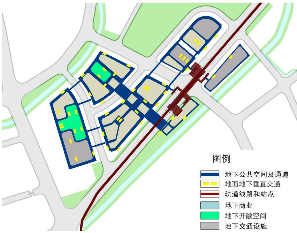
图6.8 设置地下通道穿越道路，结合地下商业开发服务相邻街区
