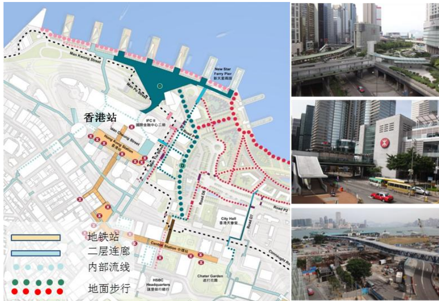
图6.11 架设二层连廊延伸轨道站点服务范围、优化步行环境
